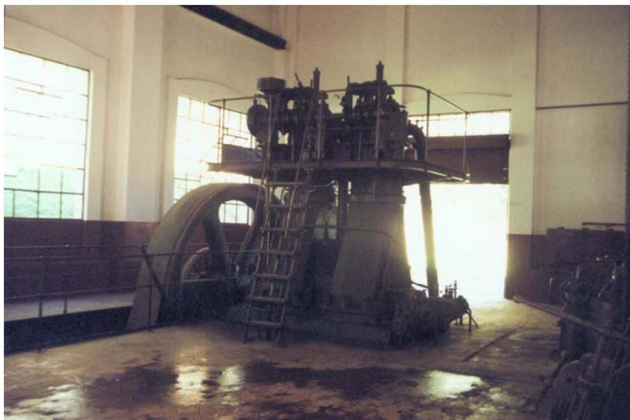
Vista geral da bomba a diesel no detalha a esquerda a correia que aciona as polias
