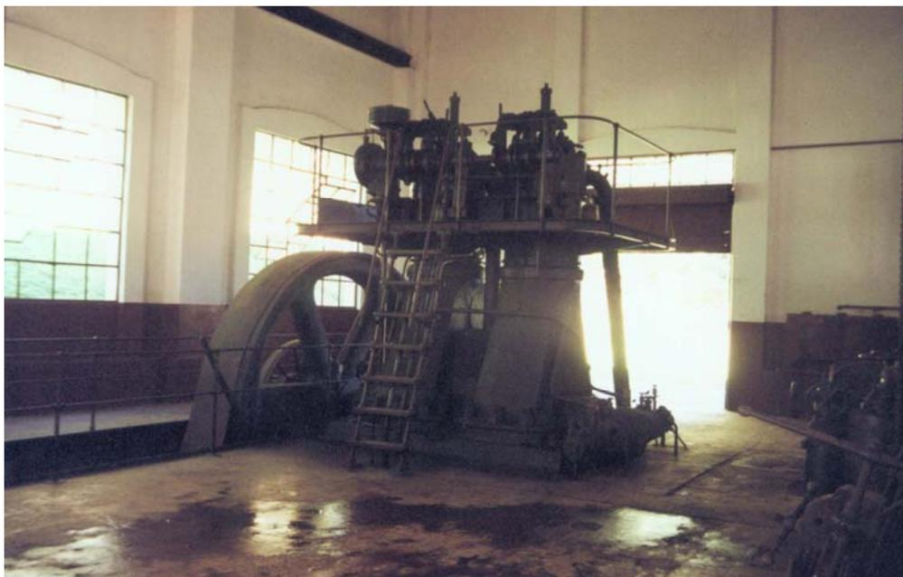
Figura 23 - Bomba a diesel, no detalhe a correia que aciona as polias 2007
