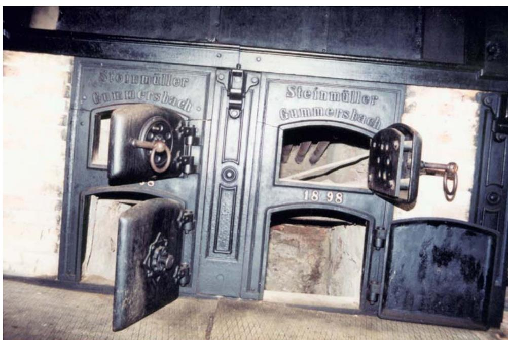
Figura 19 - Detalhes do forno de fabricação alemã, 1898 - 2007
